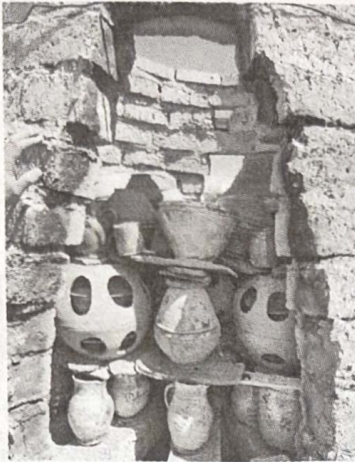
Aizmūrēto lūku atverot, skatam parvērās šāda aina. Trauki salikti smuki kārtu kārtām. Šajā ceplī Rūdolfš salicis ap 200 trauku, piepildot apmēram 60 procentus no tilpuma.
